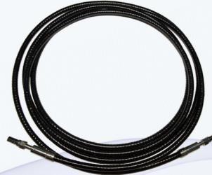
使用特殊包层大芯径能量光纤，采用优质不锈钢软管保护。根据客户需求匹配纤芯 & 包层直径，设计光纤 - 连接器 - 护套连接工艺，经精密抛磨、高效清洗端面，实现高效率耦合和高功率稳定传输。
