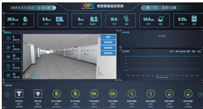
长飞 ACU 管理系统是一款针对 ACU 产品特点打造的物联网管理平台，系统引入了大数据、云计算、物联网、3D 可视化、移动互联等信息技术，基于边缘计算快速采集 ACU 数据，对工业现场环境指标、工业设备运行状态、实时数据趋势、报警与故障诊断等信息进行实时显示，并提供数据统计与分析、设备远程控制、运维管理等功能，ACU 管理系统可基于全光网进行信息传输，具有通信时延小、传输安全等特点。
