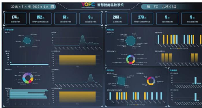
长飞 ACU 管理系统采用雷达图、条形图、趋势图、饼图、柱状图等形式，从多个维度对接入 ACU、传感器及工业设备运行状态、运维管理、报警、故障等信息进行统计，并且结合大数据分析技术，提供趋势预测等功能。
